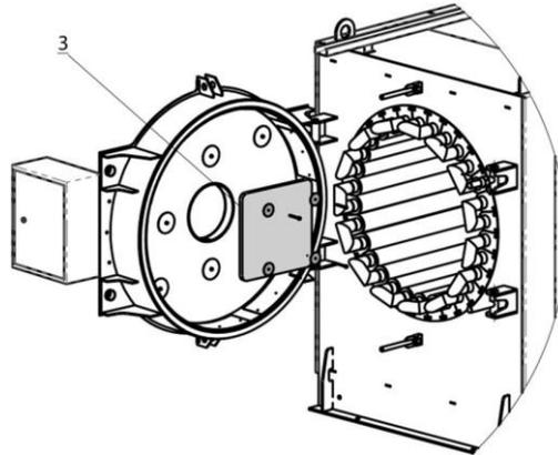
**3.** Снять с горелки сопло с головкой сгорания (4).
