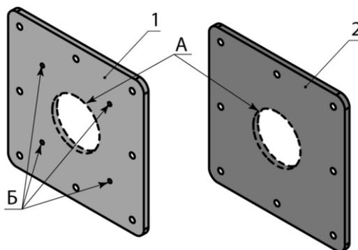
6. Закрепить пластину (1) с помощью болтов и шайб на переднюю крышку котла, предварительно уложив прокладку (2).
