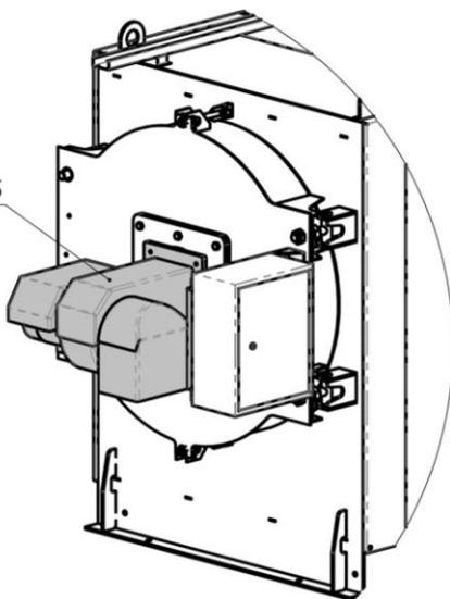
**8.** Закрепить сопло с головкой сгорания (4) на горелку, предварительно установив огнеупорную плиту (3).
