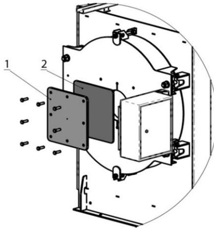
**2.** Открыть переднюю крышку котла, снять огнеупорную плиту (3).
